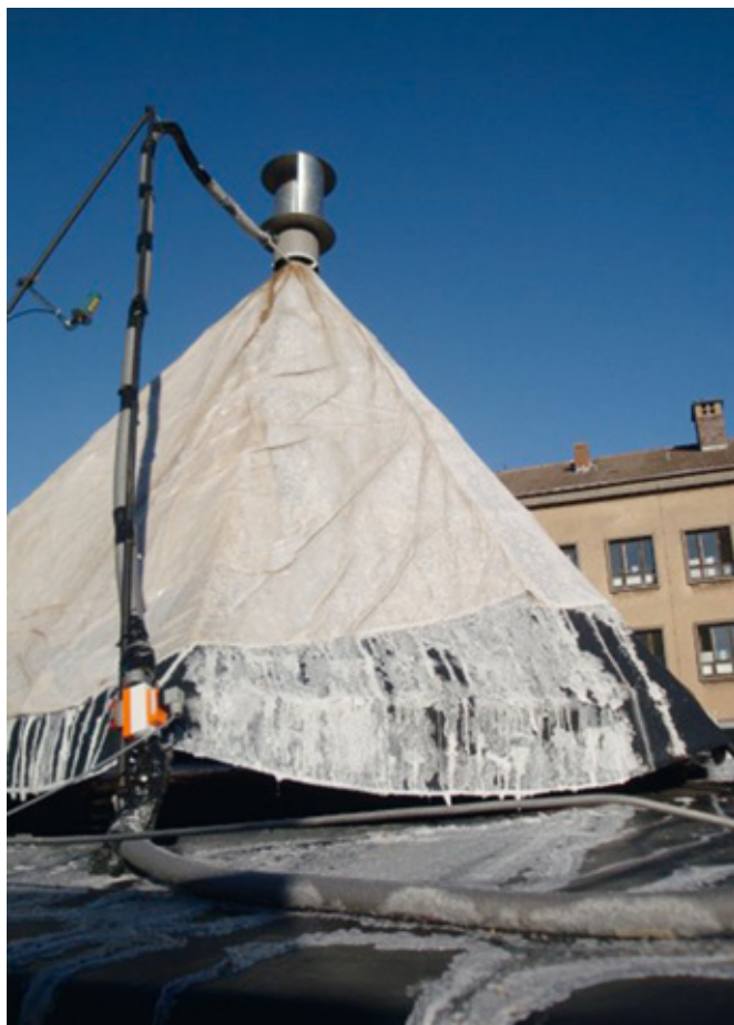
Test in Sachsen: An der Bergakademie Freiberg bei Dresden wird ein Versuchskegel mit Salzlauge besprüht. Die Salzbildung ist schon erkennbar.
